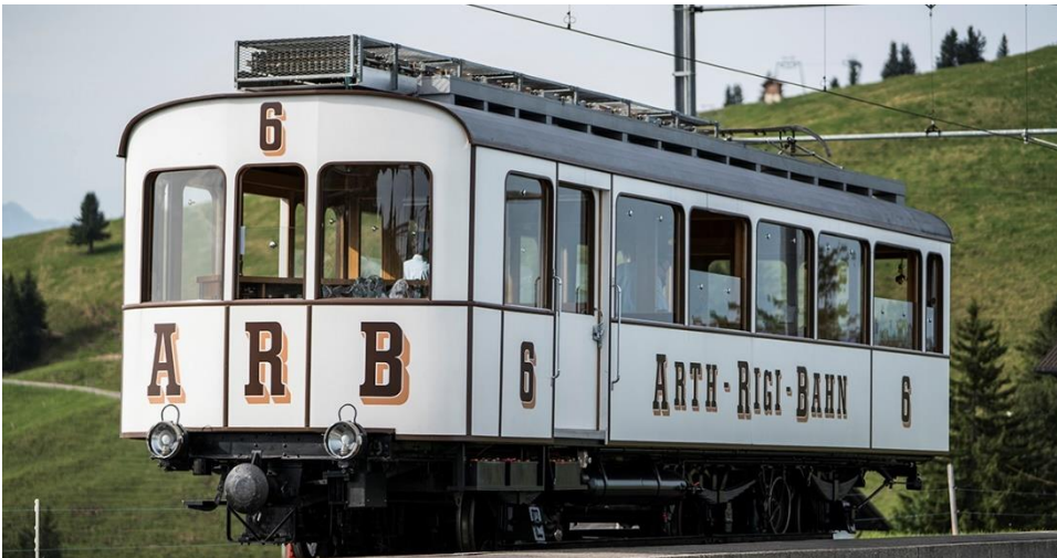
Triebwagen Nr. 6, ältester elektrischer Zahnradtriebwagen der Welt aus dem Jahr 1911
