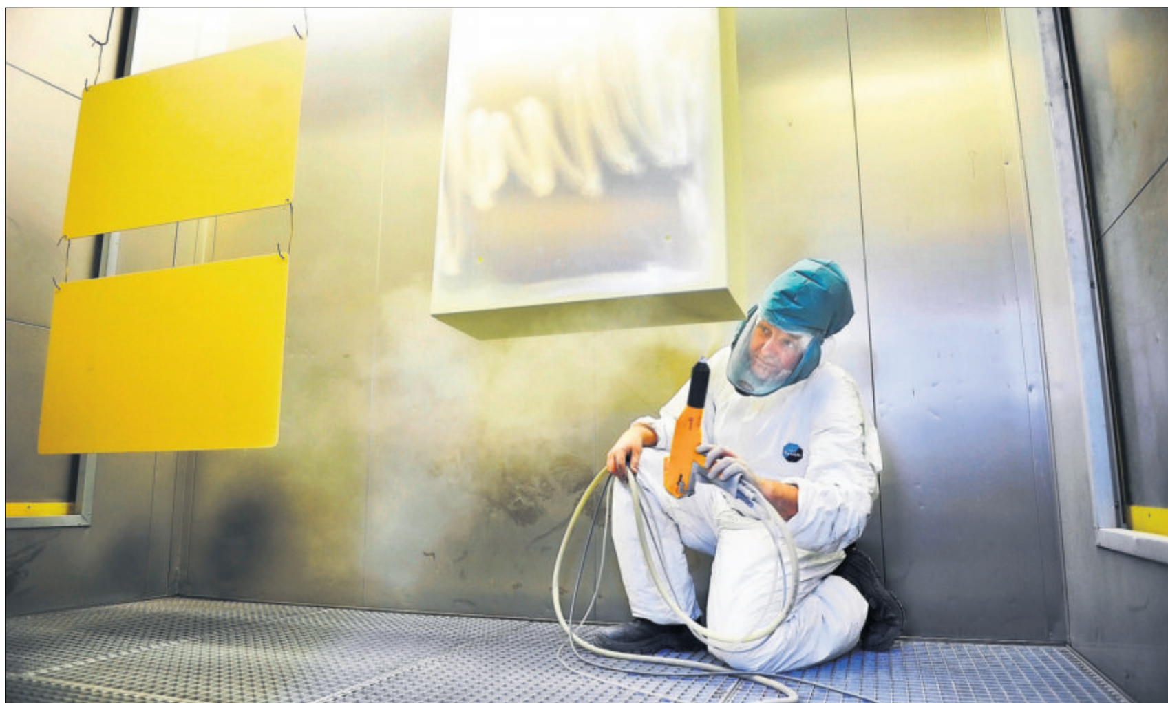
Ein Mitarbeiter besprüht Aluminiumgehäuse in der Produktion der Firma Almatec in Schüpfheim. Bild Corinne Glanzmann
